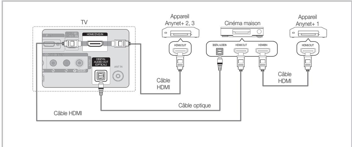
1. Raccordez la prise **HDMI (DVI) IN** du téléviseur à la prise de sortie **HDMI OUT** de l'appareil Anynet+ correspondant à l'aide du câble HDMI.
